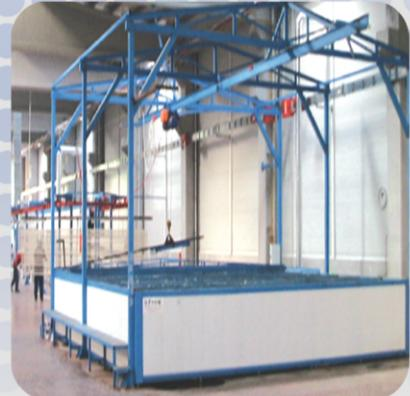
Banyo tankları Cr-Ni, Siyah sac yada PP malzemeden sızdırmazlık olarak imal edilir. Tank cıdarları ısı kaybına karşı kaya yünü ile izole edilip elektrostatik toz boyalı 1,2 mm sac ile kaplanır.
