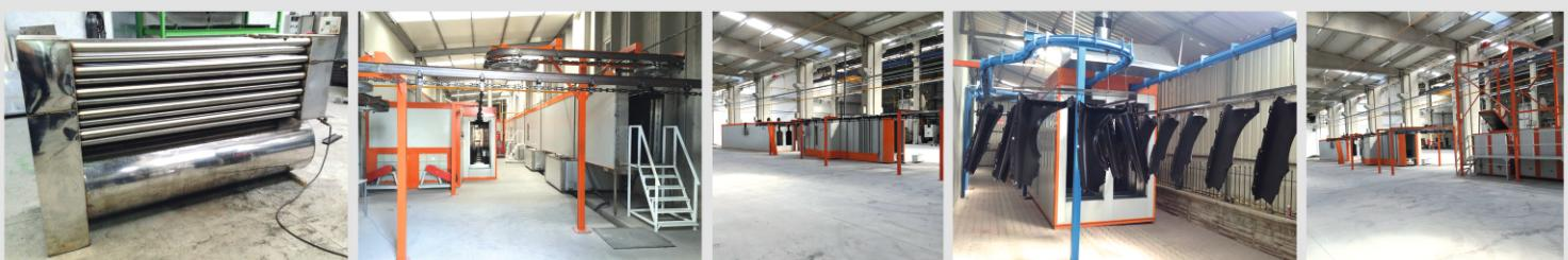
Tünel firinler kontinü çalışmalar için dizayn edilir. Konveyörlü otomatik tz boyama tesislerinde kullanılan bu firinlarda boyanan bu ürün durmaksızın istenilen sıcaklık ve sürede işlem görmektedir. Bu firinlarda malzeme durmaksızın ilerlediğinden firın giriş ve çıkış kapıları açıktır. Bu bölgelere konulan ve kapalı devre çalışan hava perdeleri firından dışarıya oluşabilecek olan ısı kaybını en aza indirger.
