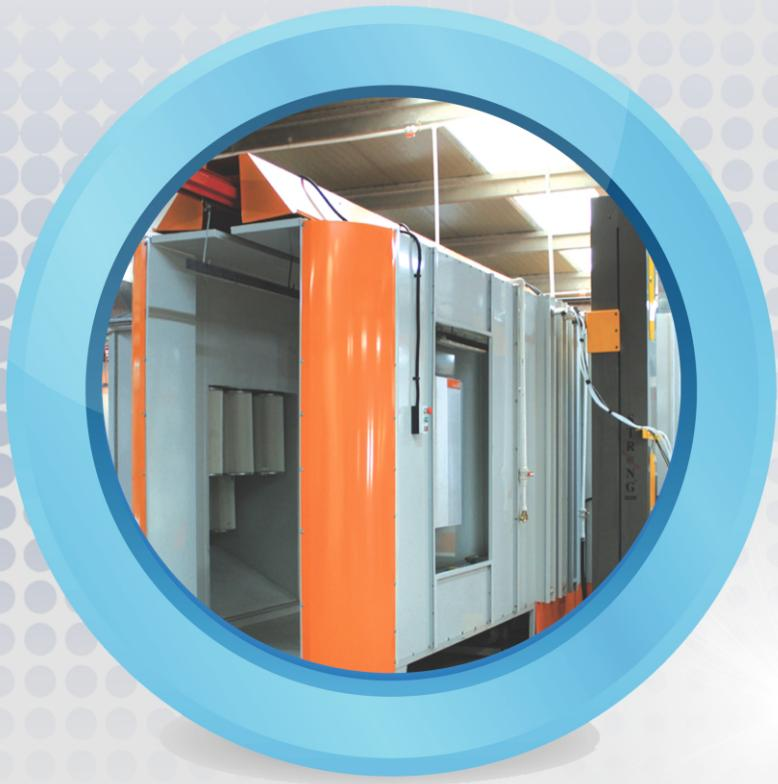
Madeni eşya, metal eşya gibi orta boy parçalarının ve gerektiğinden uzun parçalarında boyanabileceği şekilde tasarlanmıştır. Kolayca temizlenerek hızlı renk değiştirmeye uygundur. Kabinin bütün parçaları demonte olup, civata ile monte edilebilmekte, istendiğinde kolayca sökülebilmektedir. Farklı ölçülerde manuel kabinlerimiz mevcut olup ihiyacınız doğrultusunda üretilmektedir. Bu tarz kabinler filtreli ve silikonlu tip olabilir.
